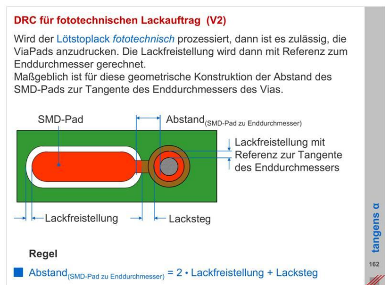
Bild 12-2 Designregel für fotosensitiven Lötstoplack
