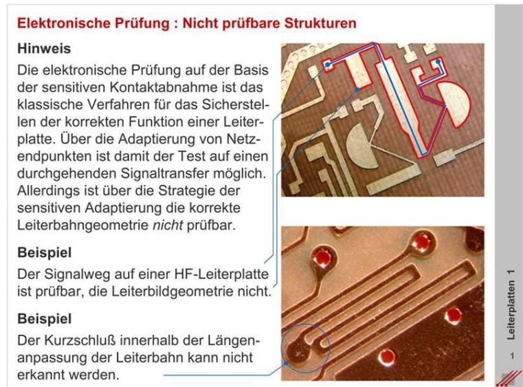
Bild 18-2 Elektrisch nicht prüfbare Strukturen
